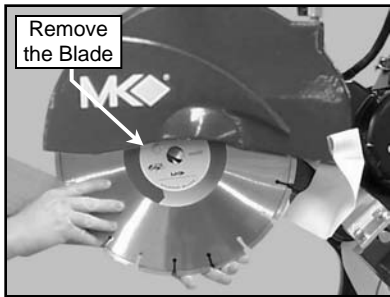
(D) Remove the old Diamond Blade
